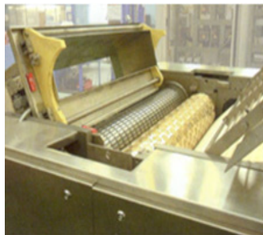
• 하드쿠키(rotary moulding) : 반죽이 원통형태에 부착되어 있는 몰드에 의해 원하는 모양으로 성형
